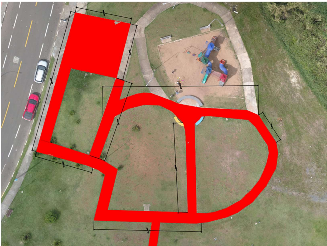
Figura 3 - Detalhe em ORTOFOTO de área de demolição
