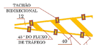
ZEBRADO DE PREENCHIMENTO DE ÁREA DE PAVIMENTO NÃO UTILIZÁVEL (ZPA)
