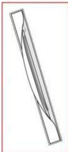
**Ombros:** Com caída de ombro de 2,0 cm para frente (tolerância de  $\pm 0,5$  cm), unidos em máquina overlock 5 fios com ponto corrente e com pesponto simples de 0,2 cm sobre as costas.
