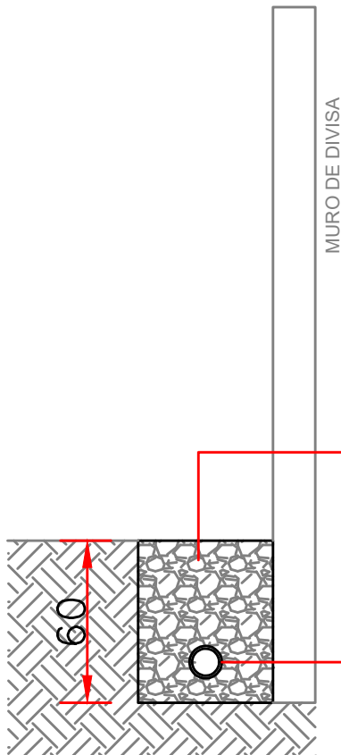
DETALHE DE DRENO ESCALA 1:25
