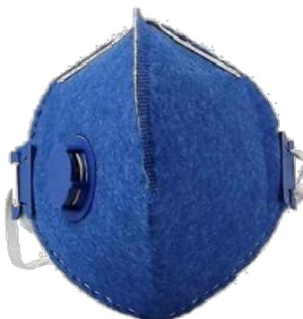
Características: Tipo respirador purificador de ar semi facial, filtrante PFF1 para partículas **com válvula de exalação**. Formato de concha dobrável com solda ultrassônica em todo seu perímetro. Fixação dos tirantes elásticos de costura ou garra plástica (tirante regulável). Na parte superior da peça fixada por uma presilha nasal para ajuste de selagem no rosto. Garantia de fábrica. Em conformidade com o INMETRO e com as recomendações contidas nas normas da ABNT no que couber.
