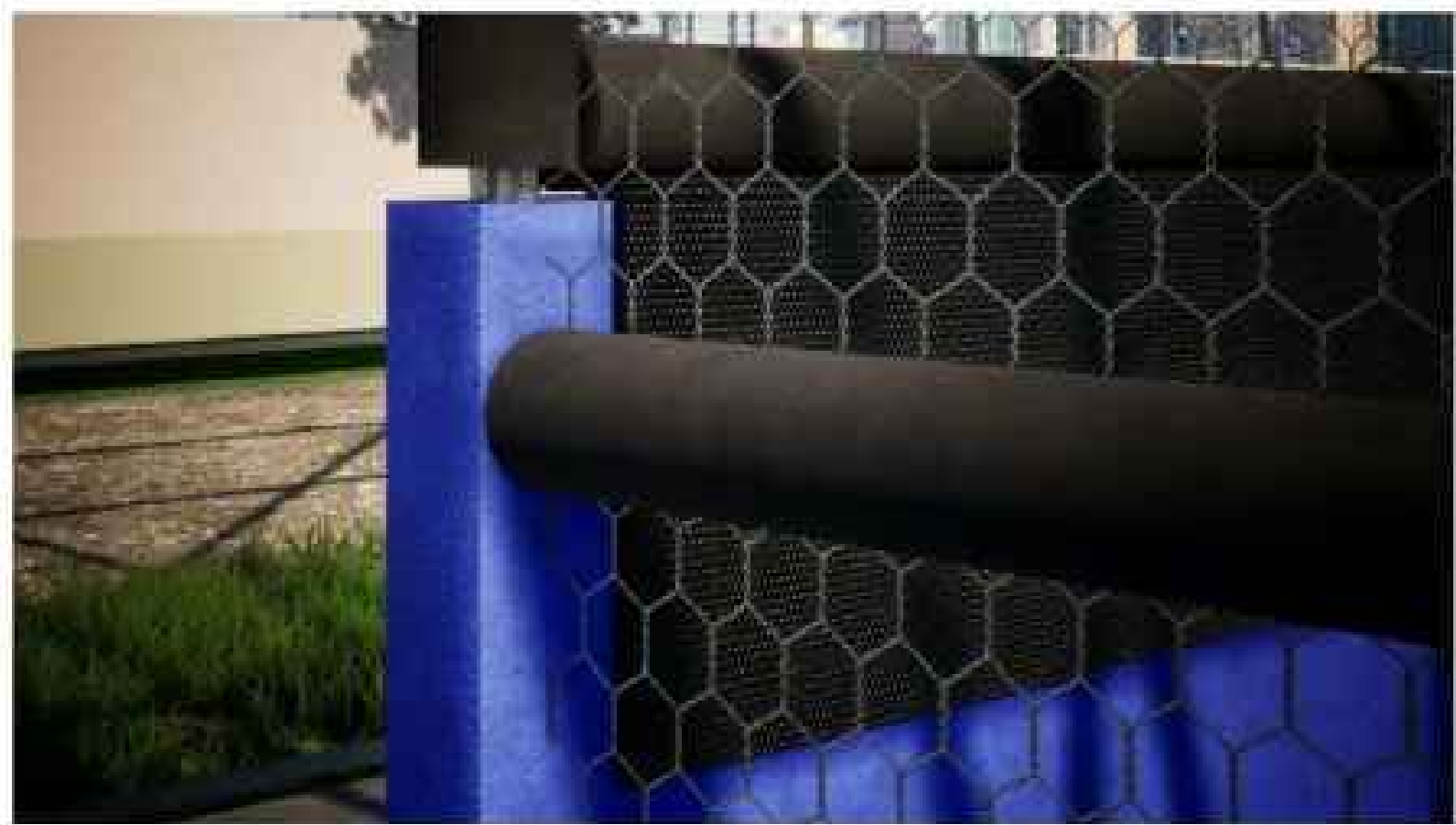
DET. A - Cantoneira e proteção parede
