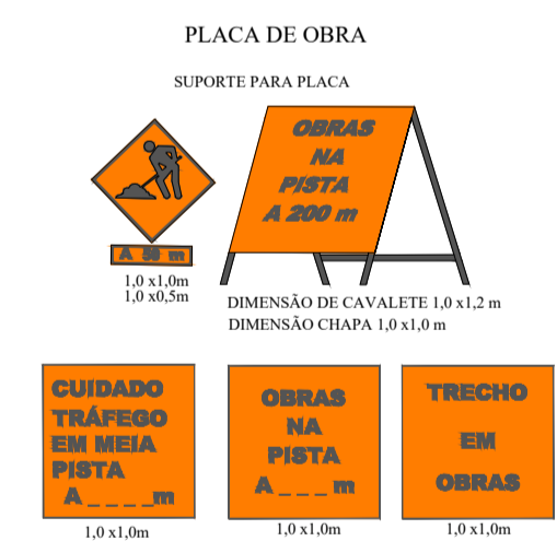
SINALIZAÇÃO DE OBRA
