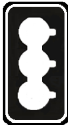
Figura: Anteparo solar para grupo focal semafórico veicular 3x200mm “T” (Padrão SEMCO)
