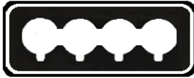
Figura: Anteparo solar para grupo focal semafórico veicular 4x200mm “T” (Padrão SEMCO)
