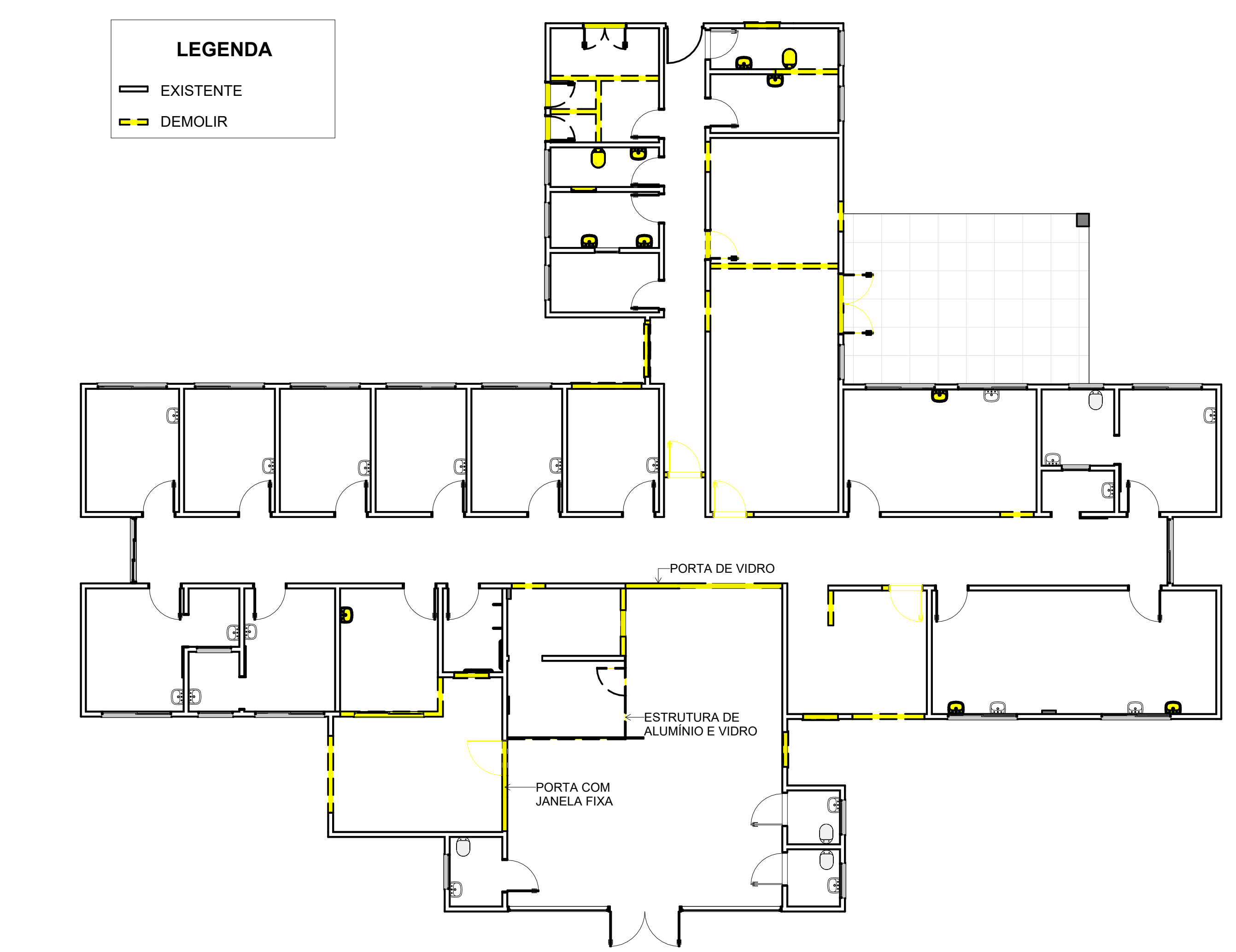
3 PLANTA BAIXA - DEMOLIR 1 : 100
