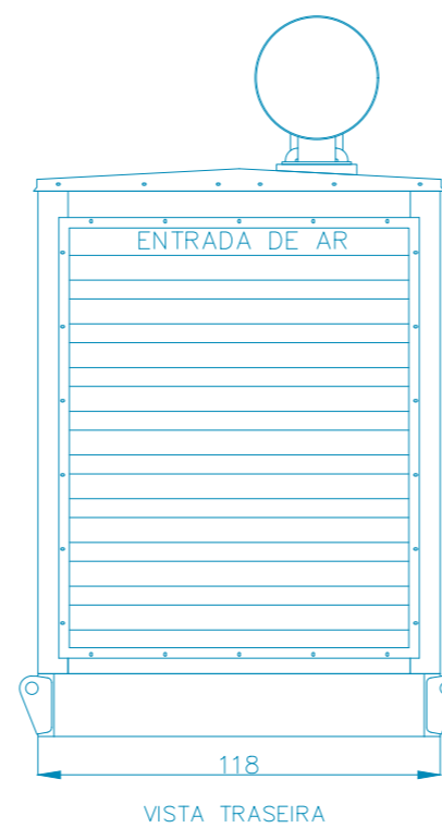
CARENAGEM GRUPO GERADOR 180 KVA: (medidas em cm)
