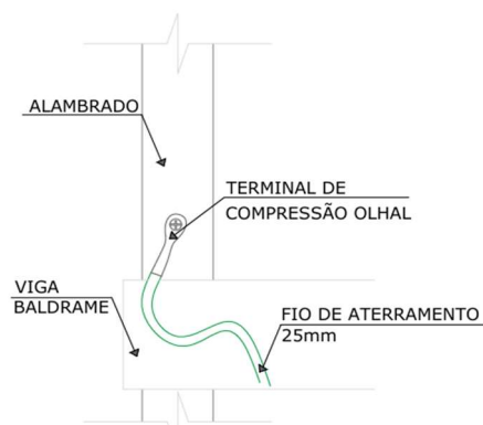
Figura 15– Detalhe de aterramento da quadra (Fonte: Autor/2025)
