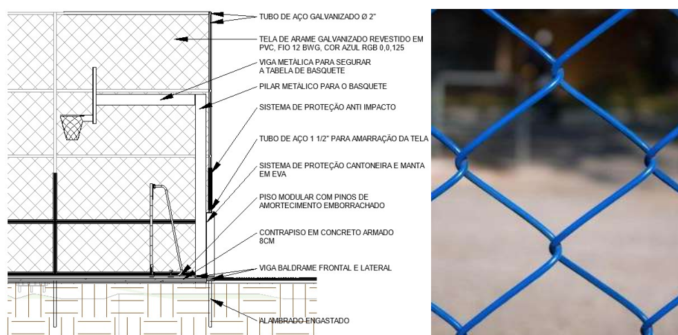
Figura 7 – Detalhe do alambrado (Fonte: Autor/2026)
