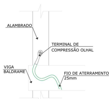
Figura 12– Detalhe de aterramento da quadra (Fonte: Autor/2025)
