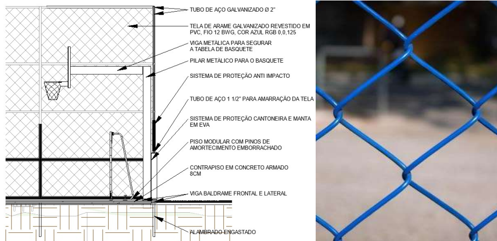
Figura 06 – Detalhe de alambrado (Fonte: Autor/2025)
