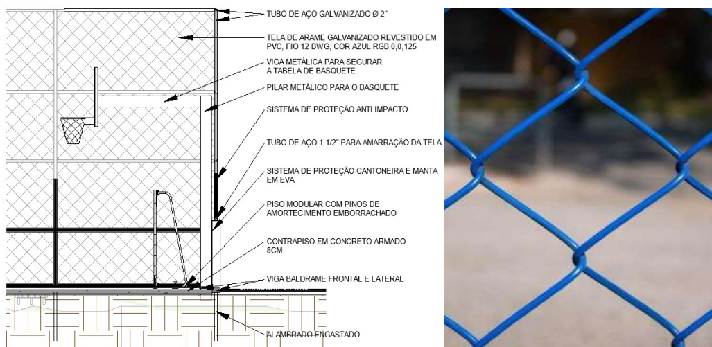
Figura 6 – Detalhe do alambrado (Fonte: Autor/2025)
