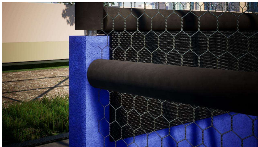
Figura 12 - Detalhe Ilustrativo da instalação do sistema de proteção das paredes (Fonte: Autor/2025)
