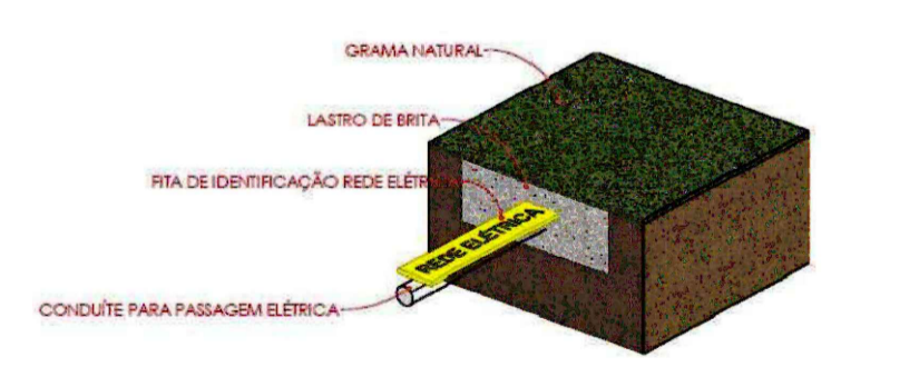
11 DET. FITA DE IDENTIFICAÇÃO REDE ELÉTRICA S/ESCALA
