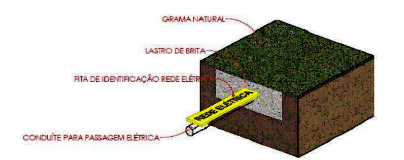
13 DET. FITA DE IDENTIFICAÇÃO REDE ELÉTRICA S/ESCALA
