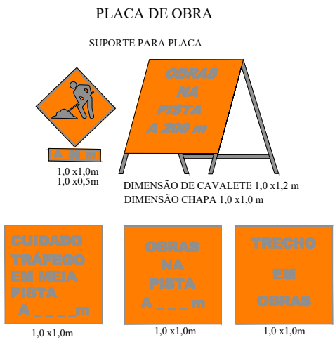
SINALIZAÇÃO DE OBRA
