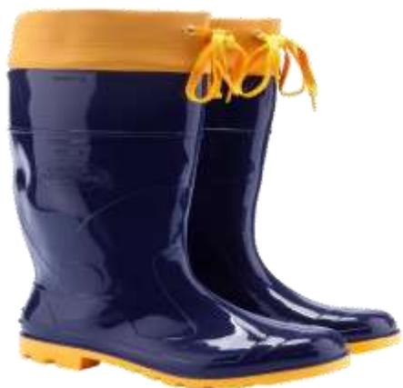
Características: Constituída de policloreto de vinila (PVC), desenho do cabedal tipo D, montagem sistema de injeção por extrusão, solado monodensidade com ressaltos, resistente à ação de óleo combustível. Região do salto totalmente fechada, com resistência ao escorregamento. Garantia contra defeitos de fabricação. Em conformidade com o INMETRO e com as recomendações contidas nas normas da ABNT no que couber.
