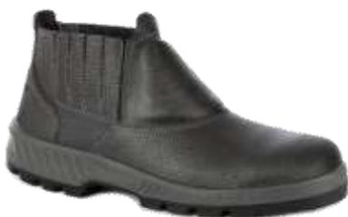
Características: Confeccionado em couro hidrofugado, na cor preta, fechamento em elástico, palmilha de montagem em não tecido, fixada pelo sistema strobel, solado de poliuretano bidensidade injetado direto ao cabedal. Garantia contra defeitos de fabricação. Em conformidade com o INMETRO e com as recomendações contidas nas normas da ABNT no que couber.
