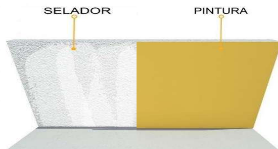
Figura 14 - Ilustração Aplicação Fundo Selador e pintura. Fonte: Google.
