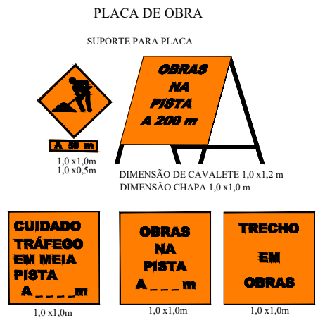
SINALIZAÇÃO DE OBRA
