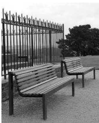
Bancos – estrutura em aço carbono e assento em madeira plástica
