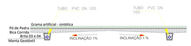
3 DETALHE INCLINAÇÃO ESC: 1/25
