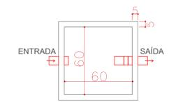
4 DETALHE PLANTA CAIXA DE INSPEÇÃO ESC: 1/25
