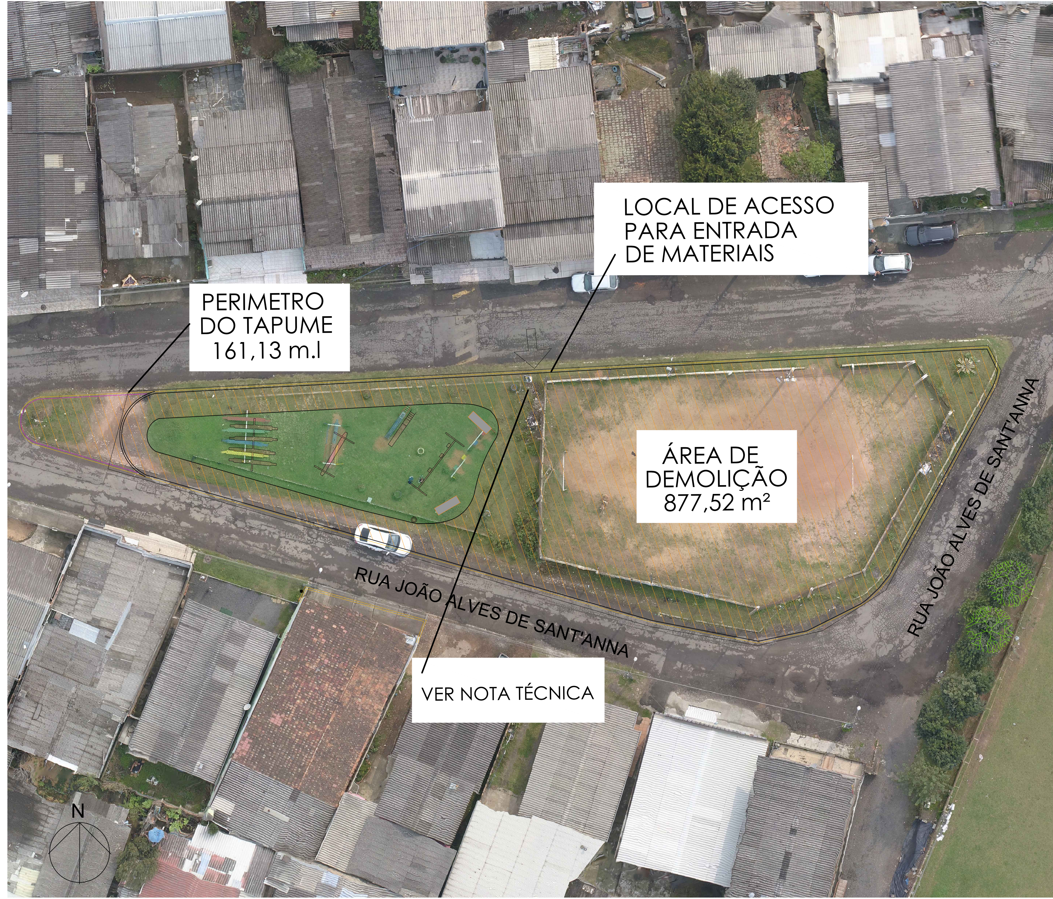
2 PLANTA DE DEMOLIÇÃO E TAPUME SEM ESCALA
